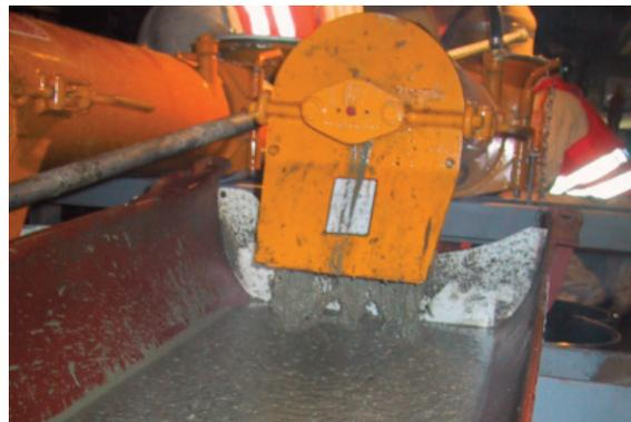
Bild 10: Misch- und Förderleistung bei 50 % Leistung bei 8000 kg ± 40 Minuten Förderung des Mischgutes in Rinnen bis zur Einbaustelle
