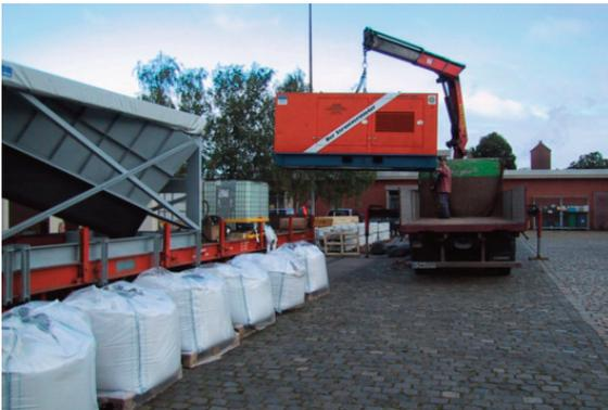
Bild 7: Aufrüstung des DB Waggon mit Förderanlage, Stromaggregat, Wassertanks und Hard- und Software-Controlsystemen
