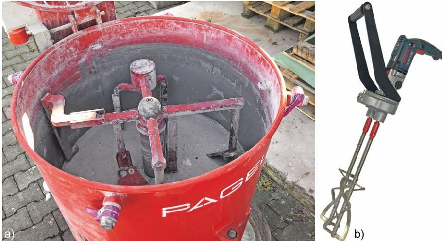
**Bild 3** Geeignete Zwangsmischer zum Anmischen von Vergussmörtel und Vergussbeton
