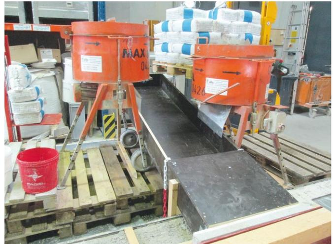
**Bild 4** Vergussaufbau mit zwei Zwangsmischern und Vergussrampe
