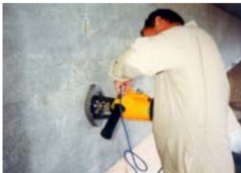
Pomiar wytrzymałości na odrywanie „pull-off”
