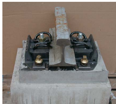
Abb. 12: Fertiggestellter Einzelstützpunktes DFF 300-1 mit Pagel Unterguss nach Einbauversuch
