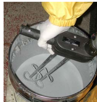
Abb. 9 u. 10: Metacrylharz Sikadur 12 Pronto (Fa. Sika) Gebinde bei Anlieferung und Mischen der Komponenten
