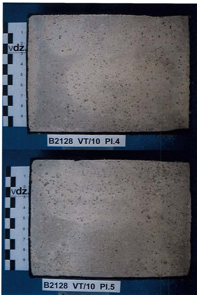
Bild 9 Probekörper VT10 - 5 nach 28 Frost-Tau-Wechseln
