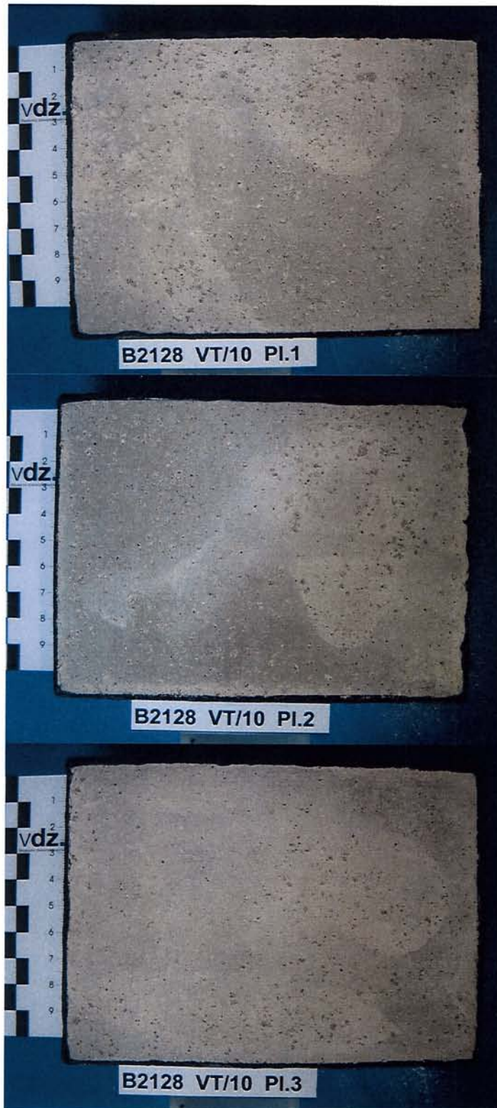
Bild 5 Probekörper VT10 - 1 nach 28 Frost-Tau-Wechseln
