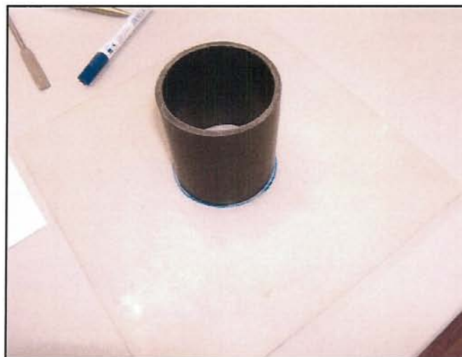
Abbildung 1: Ermittlung des Setzfließmaßes mit Hilfe eines PVC-Rohrs
