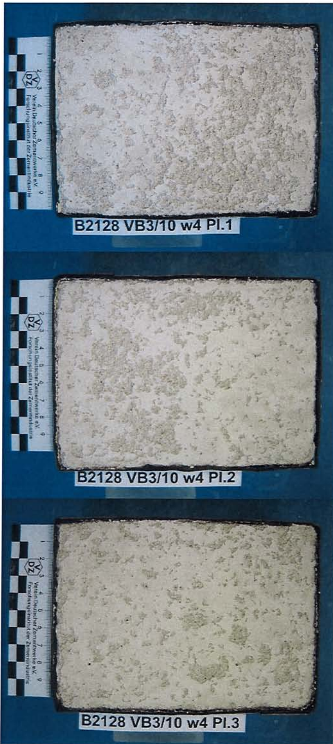
Bild 3 Probekörper VB10 - 3 nach 28 Frost-Tau- Wechseln
