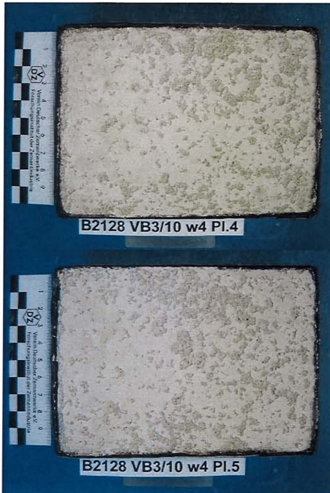
Bild 4 Probekörper VB10 – 4 nach 28 Frost-Tau- Wechseln
