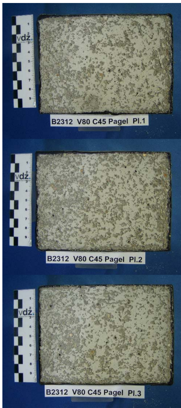
Bild 3 Probekörper V80C45 - 1 nach 28 Frost-Tau-Wechseln
