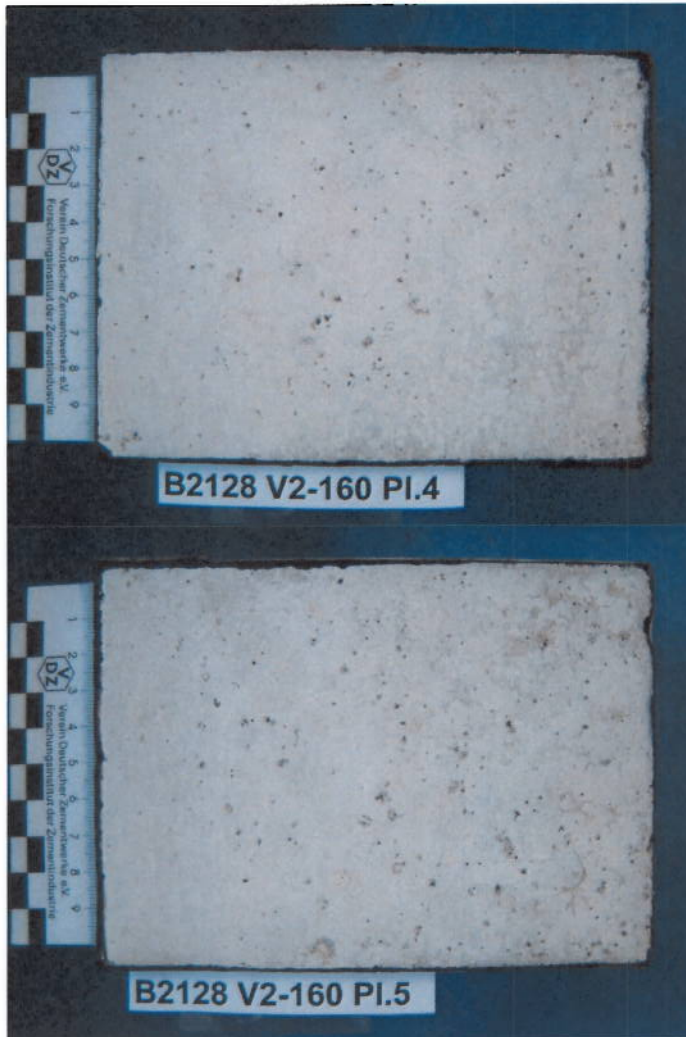
Bild 4 Probekörper V 2/160 - 4 nach 28 Frost-Tau- Wechseln
